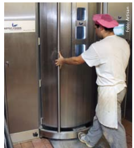
Nach einem Tastendruck beginnt die Pumpe sofort, den Unterdruck zu erzeugen.
