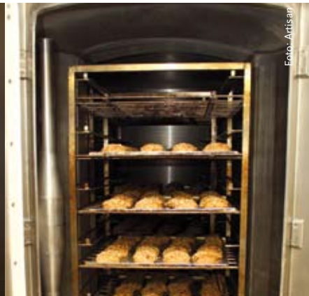
Nah bei der Batterie von Wagenöfen steht die Vakuumkammer, die auf dem Display den Status des Prozesses abbildet. Die Beleuchtung ist direkt in der Tür untergebracht. Ein Personenschutzschalter im hinteren Teil der Kammer sorgt für zusätzliche Sicherheit.
