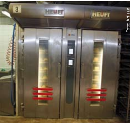
Nah bei der Batterie von Wagenöfen steht die Vakuumkammer, die auf dem Display den Status des Prozesses abbildet. Die Beleuchtung ist direkt in der Tür untergebracht. Ein Personenschutzschalter im hinteren Teil der Kammer sorgt für zusätzliche Sicherheit.
