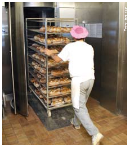
...auf einem Metallwagen direkt in die Vakuumkühlkammer.
