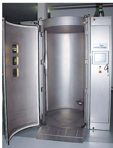
Vakuumkühler für Stikkenwagen.
